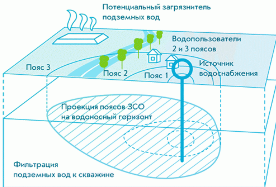
Рис. 3 Схема зон санитарной охраны источников централизованной системы питьевого водоснабжения.
